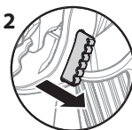
Abzug entriegelt (Spritzpistole sprüht)
