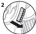
Détente débloquée (le pistolet pulvérise)
