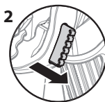
Gatilho desbloqueado (a pistola pulveriza)
