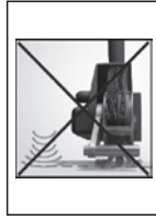
Weniger Anpressdruck = längere Standzeit und höhere Leistung
