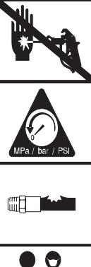
**Danger d'injection de fluide et haute pression:** la pulvérisation sous haute pression ou les fuites peuvent injecter des fluides dans le corps.
