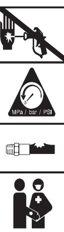
**Gefahr durch Materialeinspritzung und Hochdruck:** Durch Spritzer oder undichte Stellen kann Material mit hohem Druck in den Körper gespritzt werden.
