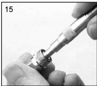
15. Coloque la junta en el alojamiento (10).
