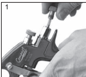
1. Retire el pomo de ajuste (7), el muelle (8), y la aguja (9).
