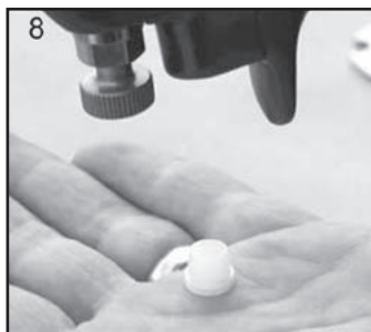
8. Ponga la pistola boca abajo y deje que se caiga la junta.
