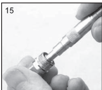
15. Coloque la junta en el alojamiento (10).
