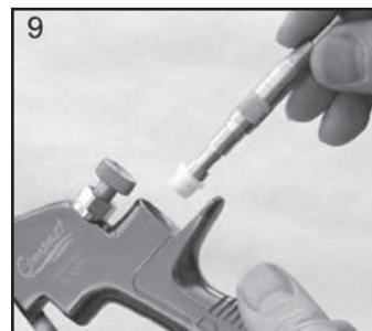
9. Instale una junta delantera nueva en la herramienta de mantenimiento.
