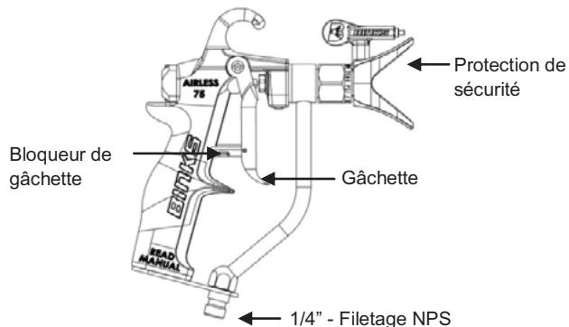
Si la buse BINKS **PIT BULL** d'origine est utilisée, suivre les instructions ci-dessous pour installer le protège-buse et la buse. Si une buse différente est utilisée, suivre les instructions d'installation fournies avec la buse en question.
