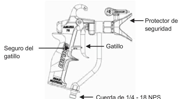
Si usted está usando una punta genuina de BINKS, siga las siguientes instrucciones para instalar el protector y la punta. Si está usando una punta diferente, siga las instrucciones provistas con la punta que esté usando.
