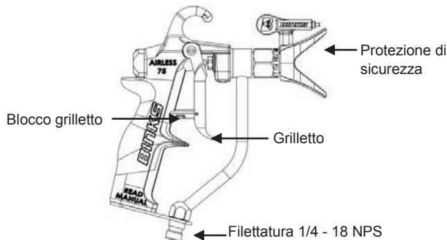
Se si utilizza un ugello BINKS PIT BULL originale, seguire le istruzioni sotto riportate per installare la protezione e l'ugello. Per tipi diversi di ugello, seguire le istruzioni per l'installazione fornite con l'ugello utilizzato.
